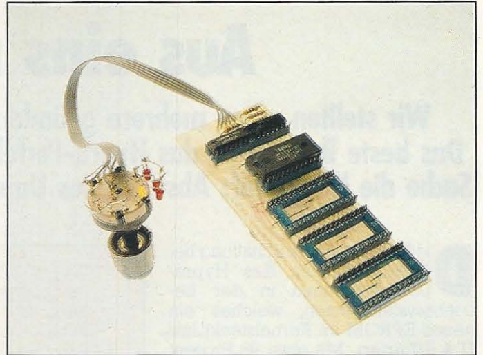
Bild 5. Die fertige Umschaltplatine. Achten Sie auf die Drahtbrücken
